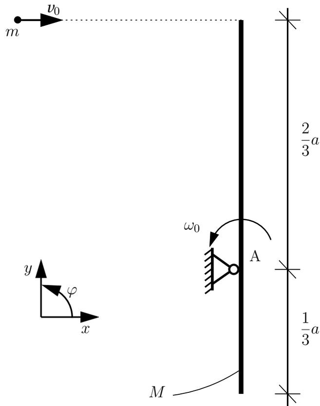
Eine Rückschlagmaschine für Bälle besteht aus einem homogenen Stab (Masse  $M = 6m$ , Länge  $a$ ), der mit der Winkelgeschwindigkeit  $\omega_0 = 3\frac{v_0}{a}$  um das Lager A rotiert. Ein Ball mit der Masse  $m$  (Punktmasse) trifft mit der Geschwindigkeit  $v_0$  genau dann auf das obere Ende des Stabs, wenn sich dieser in der skizzierten vertikalen Position befindet. Die Stoßzahl ist  $e$ .
