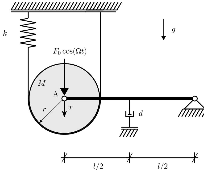
Eine homogene Scheibe (Masse  $M$ , Radius  $r$ ) ist in A drehbar an einem masselosen, starren Balken befestigt. In dessen Mitte befindet sich ein Dämpfer mit der Dämpfungskonstante  $d$ . Über die Scheibe wird ein masseloses, dehnstarres Seil geführt, an dessen Ende sich eine Feder mit der Federkonstanten  $k$  befindet. Rutschen zwischen Seil und Scheibe ist ausgeschlossen.
